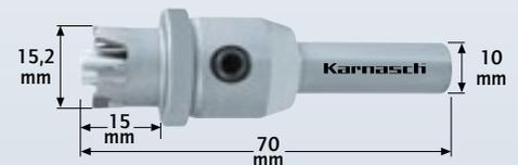
**Zu verwenden mit einer Bohrmaschine/starke Akku-Bohrmaschine.** Mit dieser Lochsäge ist es möglich, die vor dem Kern liegende, gehärtete Stirnplatte dieses speziellen Hochsicherheitszylinders zu durchdringen um anschließend den Kern herausziehen zu können. Werkzeugmerkmale:
