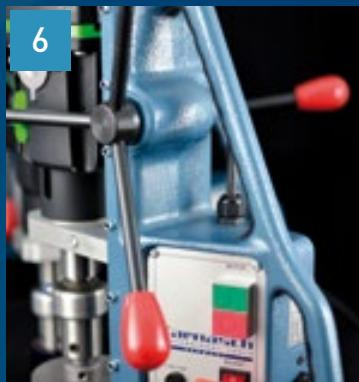
Ergonomische 2-fach Griffe zum "ausbalancierten" Halten / Befestigen der Maschine.
