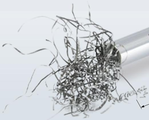
2. SCHRITT: Lösen Sie die Späne durch Ziehen des Stabs und des innenliegenden Magneten.
